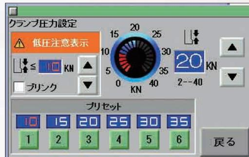
クランプの圧力設定がディスプレイ上から行えます。2KNから40KNまで1KNごとに数字で設定でき、圧力設定のパラッキをなくします。5KNごとのプリセットの他、コース、ページごとの圧力の設定も可能。品物の特性に応じた圧力や断裁位置の圧力など作業に適した設定を行う事で、完成度の高い断裁ができ、圧力の間違いでのヤレ防止にも最適です。
