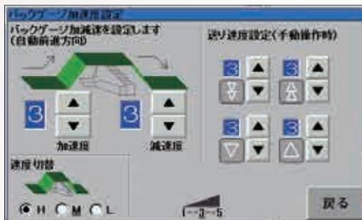
バックゲージの動きを、スピードだけでなく動きはじめの立ち上がり速度から減速して停止するまでの一連の動きをコントロールできます。ワークの崩れ防止に最適です。
