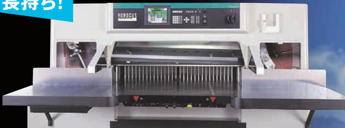
左右それぞれのウォームギアでナイフを駆動する、イトーテック伝統の両引きスウィング駆動は、引きながら押し込む独自のスイング角と相まって抜群の高精度を誇ります。その信頼性は世界の現場で認められ、様々な分野で稼働しています。
