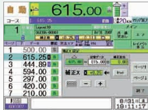
断裁データと印刷物の位置ずれを補正する機能です。印刷の位置がずれている場合、オペレーターは断裁データに補正值を入力し直す必要なしに、トンボに合わせて断裁するだけで記憶データのずれを自動的に計算した補正量で記憶します。
