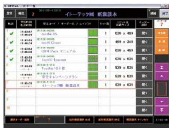
CIP4 Pack は、常にオペレーターの使いやすさを根底に置いています。受けとった CIP4/JDF データを、名前の付いた仕事として画面で確認できるから安心。また、目の前の刷本と照合しながら断裁機へ転送できるから安全です。指で触れるだけのタッチパネルはマウス操作などの場所もいらず、より軽快に操作が行えます。
