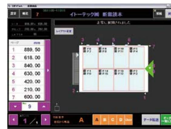
オペレーターが仕事の主役。そう考えるイトーテックは CIP4 Pack で様々な便利機能を提供しています。たとえば、仕事を決めると CIP4 Pack は素早く4種類の断裁手順を表示します。その中からオペレーターが最適な断裁手順を選んで eRC 断裁機に転送することができます。
