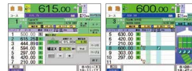
印刷の位置がずれている場合、トンボに合わせて断裁するだけで記憶データのずれを自動的に計算した補正量で記憶します。
